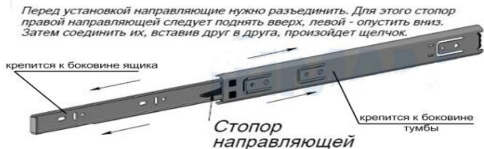
Рис.2 Схема установки шариковых направляющих
