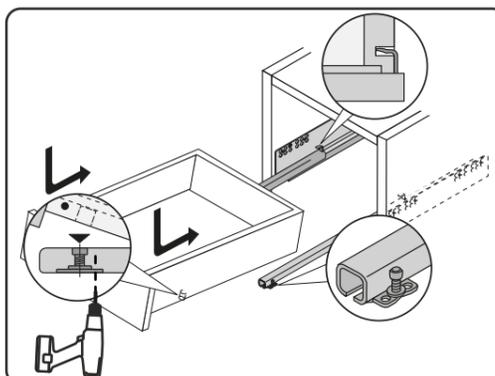
При желании, закрепите ящик к направляющим дополнительным саморезом 3x16, в комплектацию саморез не входит.
