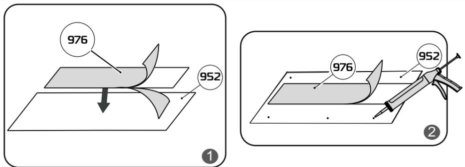
для более сильной фиксации рекомендуем использовать дополнительно клей-герметик типа жидкие гвозди. (Scotch-Seal 5300; Scotch-Wld 5300)
