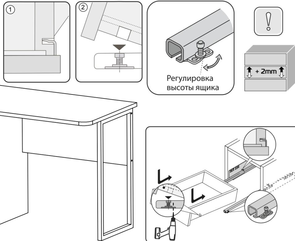
При желании, закрепите ящик к направляющим дополнительным саморезом 3x16, в комплектацию саморез не входит.
