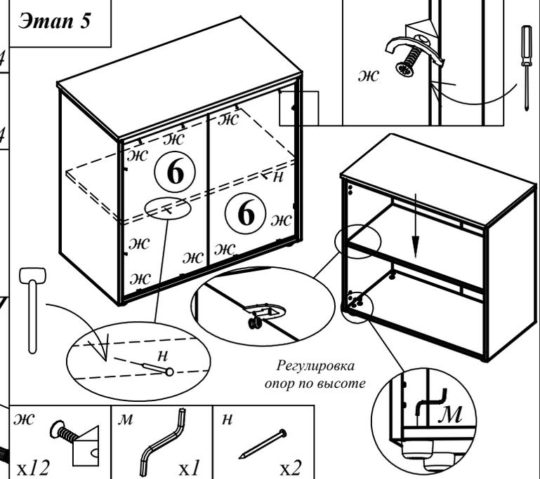
Регулировка опор по высоте
